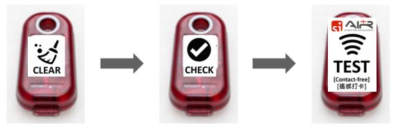
SPORTident Air+ 是指卡和打卡器毋須接觸的電子計時系統。是次賽事中,打卡器和 SIAC 指卡的有效範圍為 <u>30</u> <u>厘米(約一個定向燈籠的大小)</u>。如果打卡成功, SIAC 指卡會發出聲響及閃燈確認。如果沒有以上訊號, 賽員須 回到控制點重新打卡。
