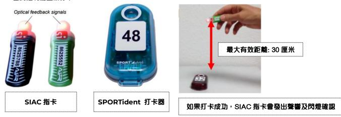
根據廠方資料,如果指卡沒電,指卡將不能使用隔空打卡功能。如果指卡在打卡器 30 厘米範圍內皆無閃燈或聲響, 請將指卡當成普通 S1 卡使用(即將指卡直接接觸打卡器)。賽員不能以系統失效作為抗辯理由。
